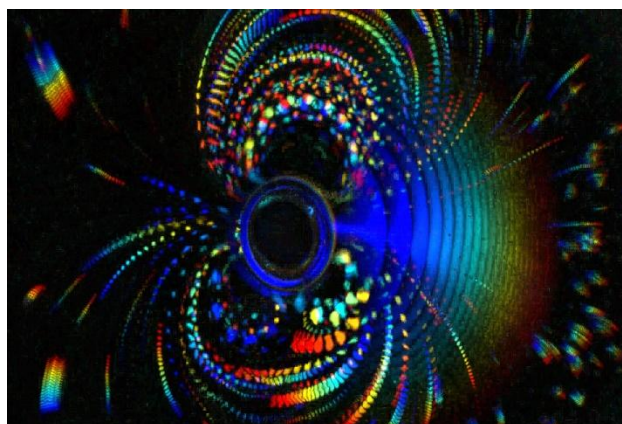
Rysunek 1. Dynamika obrotu cząstek w wirze fotonicznym (kolor odpowiada poszczególnym etapom ruchu).
